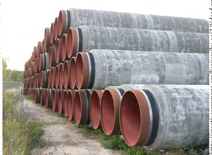
Stapel av rör för naturgasledning North Stream 2 vid Mukran hamn
